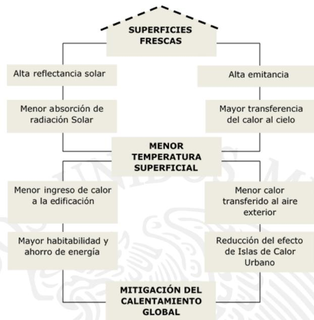
**Figura 2 - Beneficios de los revestimientos con alto índice de reflectancia solar**
