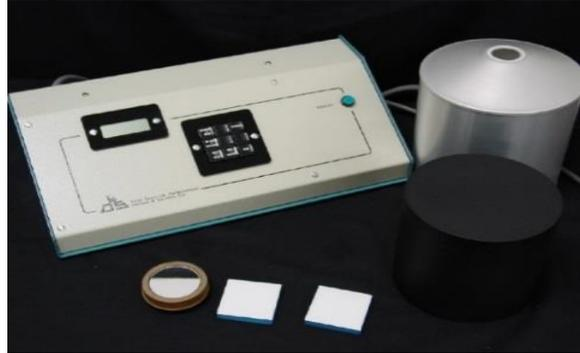
**Figura 8 - Reflectómetro solar portátil**
